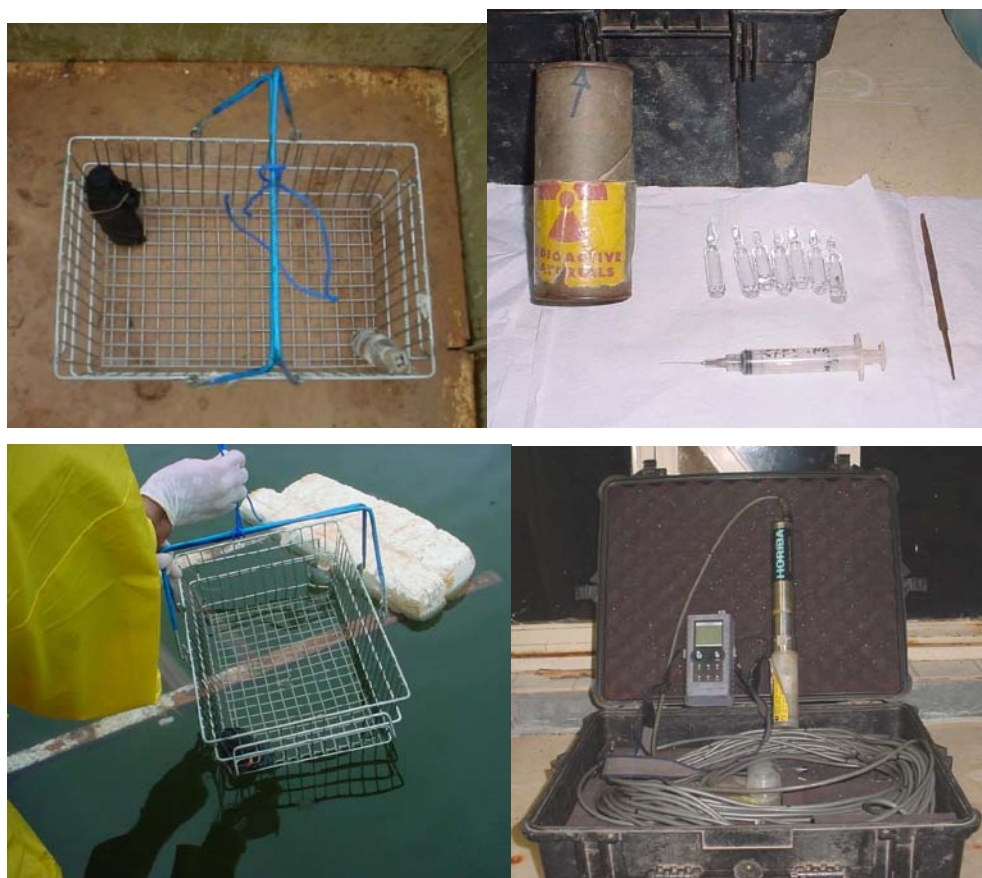
Figura 20 – Frascos claros e escuros, ampolas de \text{NaH}^{14}\text{CO}_3 , incubação dos frascos in situ e aparelho multiparâmetros Horiba U-22.
