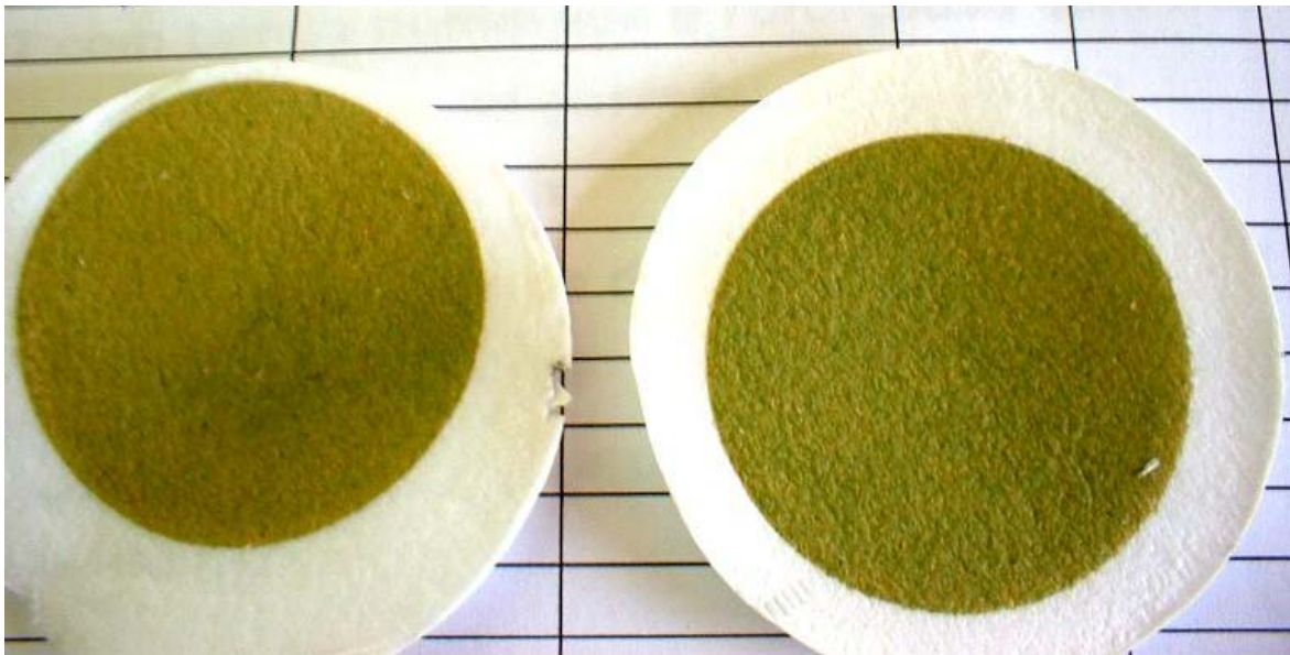
Figura 15 - Filtros de fibra de vidro de 47 mm de diâmetro (marca Millipore) imediatamente após serem usados em um processo de filtração sob pressão negativa (à vácuo). Nota-se que as algas ficam retidas na fibra do filtro. Esses filtros são congelados a seco e mantidos no escuro até a data de seu processamento final.
