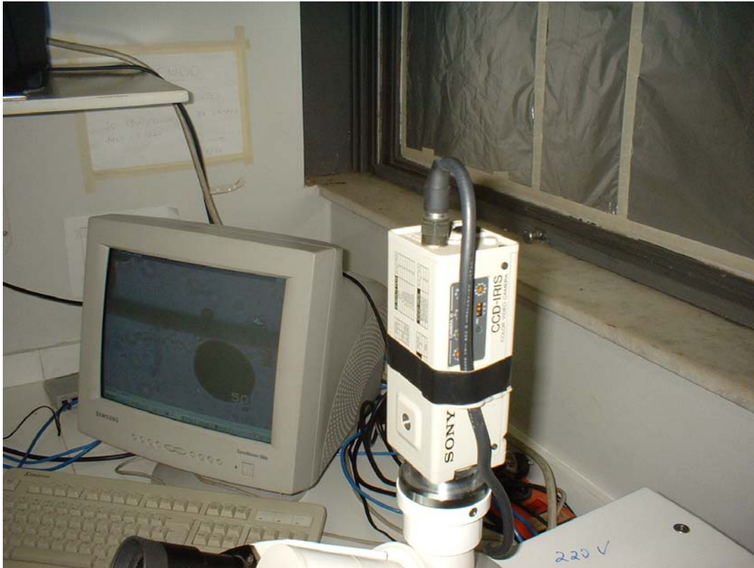
Figura 18 – A enumeração dos organismos zooplancônicos será feita sob microscopia ótica convencional (dois microscópios Leica DMB e um estéreomicroscópio Leica 3M), acoplados a um sistema de aquisição de imagens dotado de câmera CCD Sony acoplada a um computador Desktop dotado de software que permite fazer mensurações e gravar imagens.
