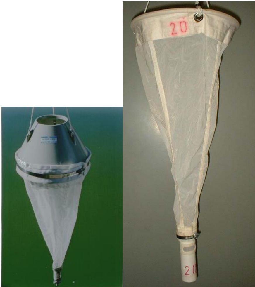
Figura 16: redes cônicas utilizadas para coletar organismos fitoplanctônicos. Normalmente essas redes apresentam a abertura de poro ao redor de 20 \mu\text{m} .
