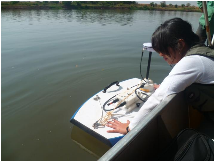
Figura 3 – Sistema M9 com GPS Diferencial e transmissão Bluetooth utilizado em campo. Foto: José F. Bezerra Neto, 06/09/2012.
