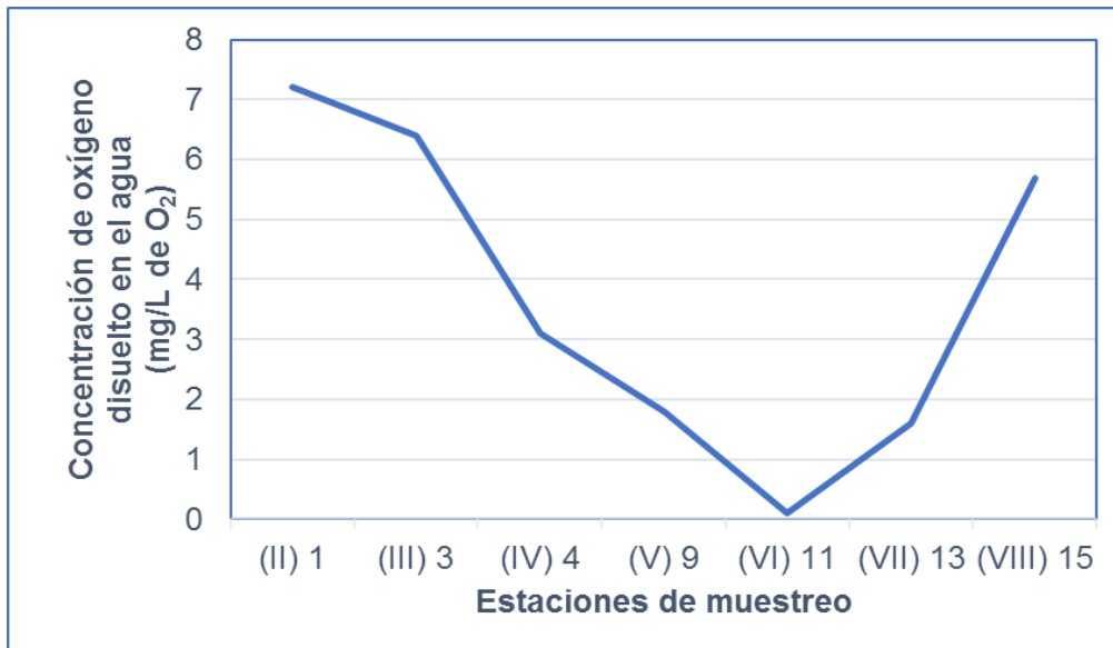
Fig. 5 - Variación del oxígeno disuelto en 7 estaciones de monitoreo del río Medellín en el año 1983. Adaptado de: Mattias & Moreno (1983).
