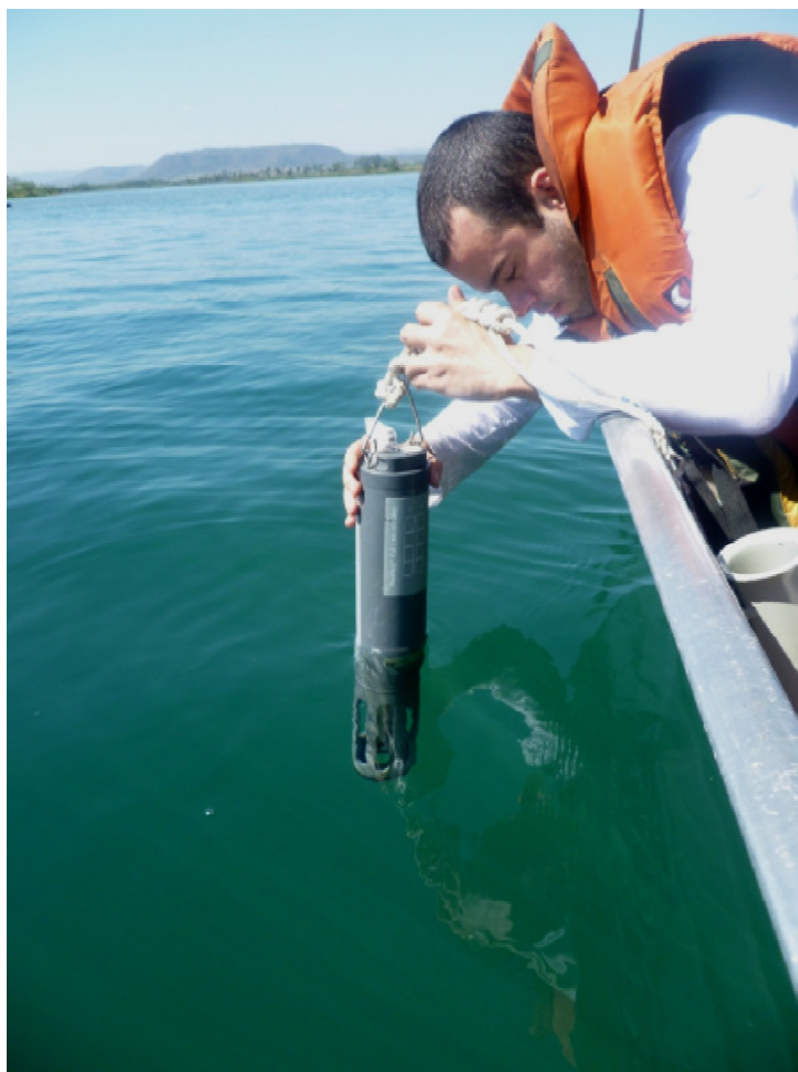
Fig. 45 – Uso da sonda Yellow Springs 5500 v2 no presente estudo. Essa sonda é capaz de monitorar e armazenar uma série de parâmetros (hora, profundidade, temperatura, oxigênio dissolvido, condutividade, pH, potencial REDOX e turbidez) obedecendo a uma programação definida. Na foto o ecólogo, Aloizio Pellinson, responsável pela obtenção dos dados com esse instrumento nas coletas dos dias 7, 8, e 9 de agosto de 2012 em Igarapava.
