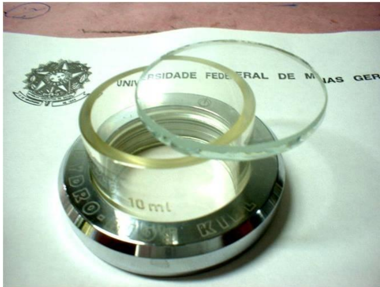
Figura – 4 Cubeta de sedimentação Hydro-Bios usada para a contagem de organismos fitoplanctônicos pela técnica de Ütermohl. Na foto, a cubeta de 10 ml de capacidade, usada nas estações oligotróficas. Nos locais mais ricos em algas, usou-se a cubeta de 5,0 ml.
