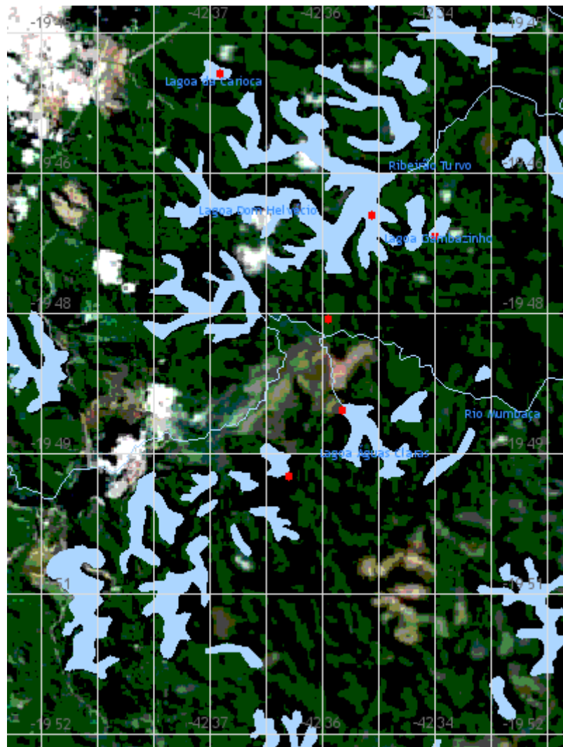
Figura 59 - Saída SIG mostrando a sobreposição de dois planos de informação: imagem landsat com a hidrografia e os lagos da região do PERD e de seu entorno imediato.
